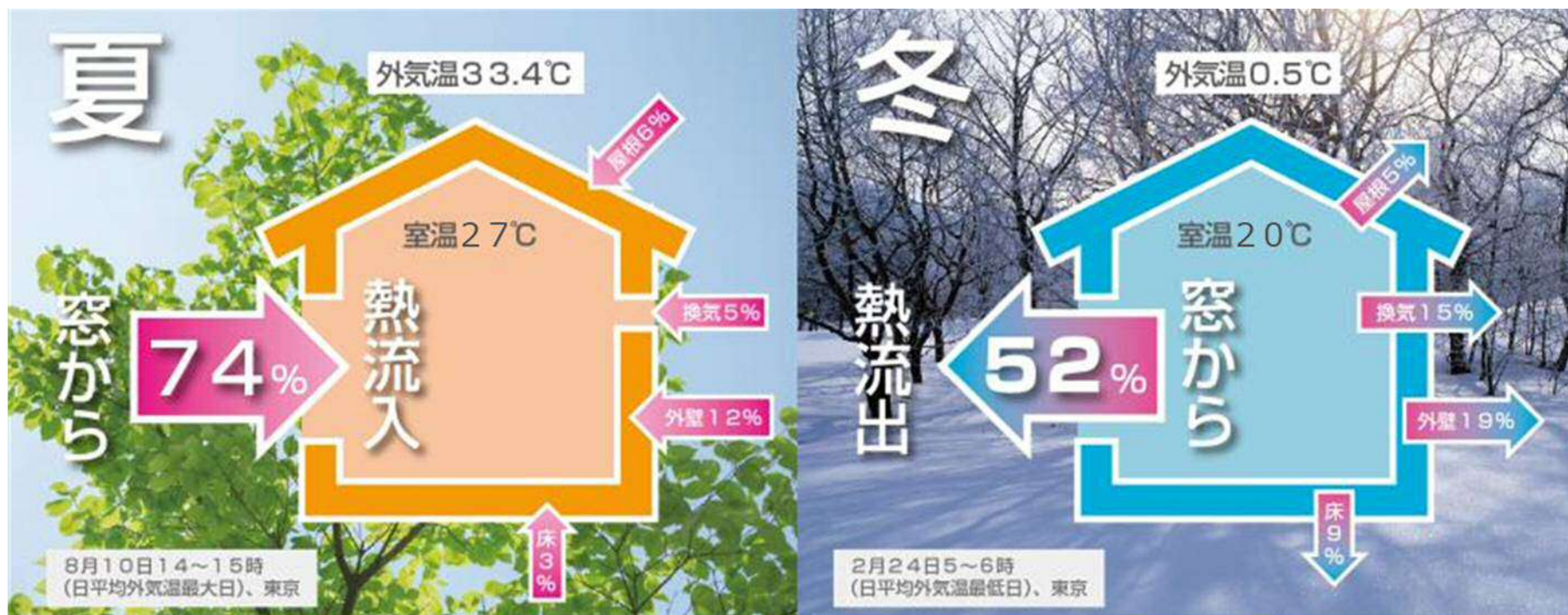
「平成25年省エネルギー基準に準拠した算定・判断の方法及び解説II 住宅」標準住戸プランにおけるAE-Sim/Heatによる計算結果 【算出条件】窓：アルミ（複層ガラス） | 躯体：平成11年省エネ基準適合レベル
