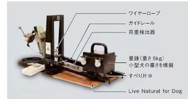
フロアにペット(犬)を想定したすべり片付きの重錘を置き、斜め上18°の方向に所定の荷重速度で引上げます。その際の引張荷重を荷重検出器で測定し、すべり片が動き出すまでの荷重の最大値を求め、次式にしたがってすべり抵抗係数「C.S.R-D」を算出します。
