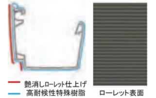
3 排水断面積の大型化
