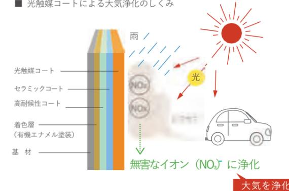
※ 光触媒コートを施した表面に当たったNOxの分子を太陽光で無害なイオンに酸化し、雨で洗い流します。
