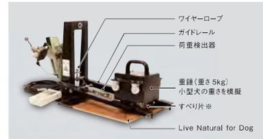
フロアにペット(犬)を想定したすべり片付きの重錘を置き、斜め上18°の方向に所定の荷重速度で引っ張ります。その際の引張荷重を荷重検出器で測定し、すべり片が動き出すまでの荷重の最大値を求め、次式にしたがってすべり抵抗係数「C.S.R-D」を算出します。
